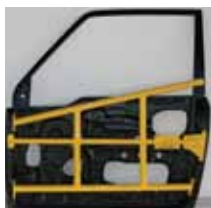
Fiancata di Commuter Car. Esempio di progetto rinforzato basato sull'analisi tecnica: massima resistenza con il minimo peso.
