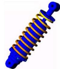
Los estudios dinámicos analizan objetos forzados por cargas que varían en el tiempo. Algunos ejemplos típicos pueden ser cargas de choque de componentes montados en vehículos, turbinas cargadas mediante fuerzas oscilatorias, componentes de aviones cargados aleatoriamente, etc. Se encuentran disponibles tanto linealmente (pequeñas deformaciones estructurales, modelos de material básico) y
